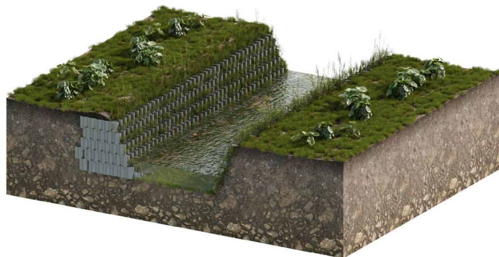
Figura 69 Contenção estrutural em Geocélulas (Fonte: Guajava, 2023).
