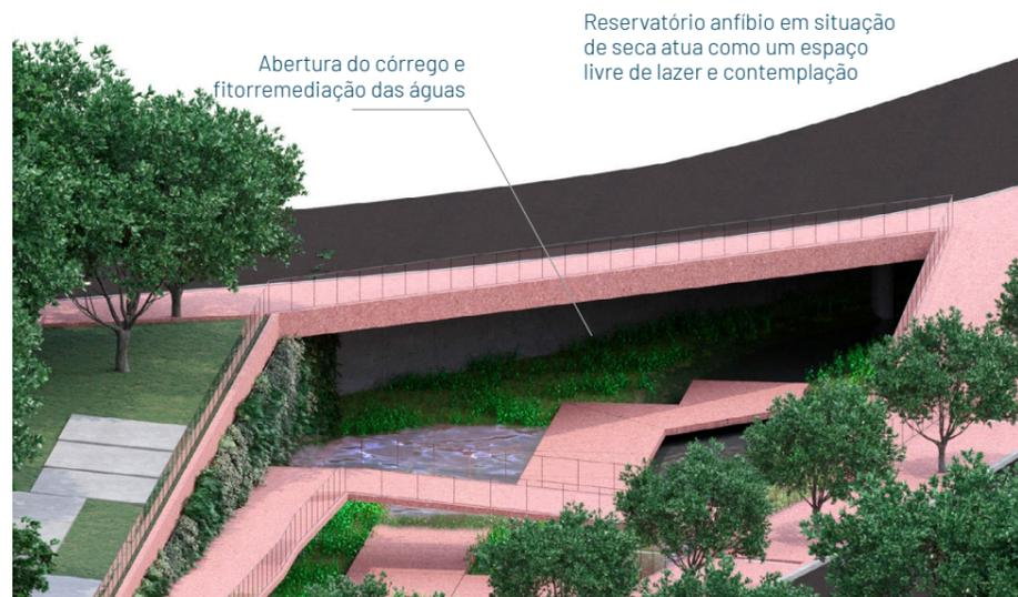
Figura 39 Reservatório anfíbio vazio, vista externa (Fonte: FCTH, 2021).
