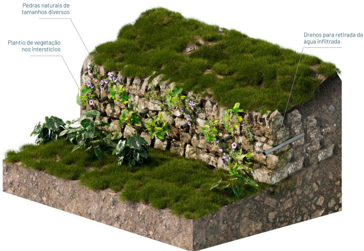
Figura 57 Muro de pedra com vegetação (Fonte: Guajava. 2023).
