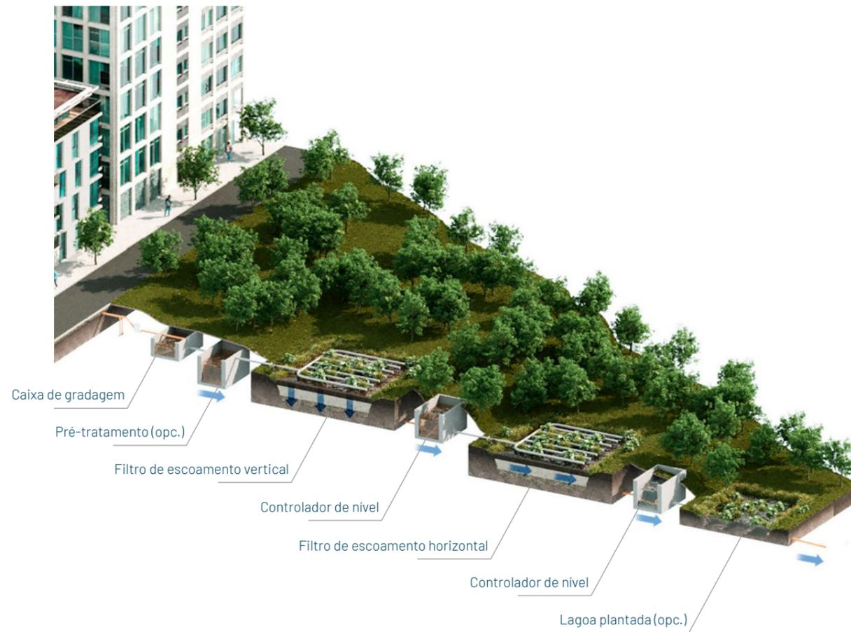
Figura 31 Sistema de alagado construído para tratamento efluente doméstico (Fonte: Guajava, 2023).
