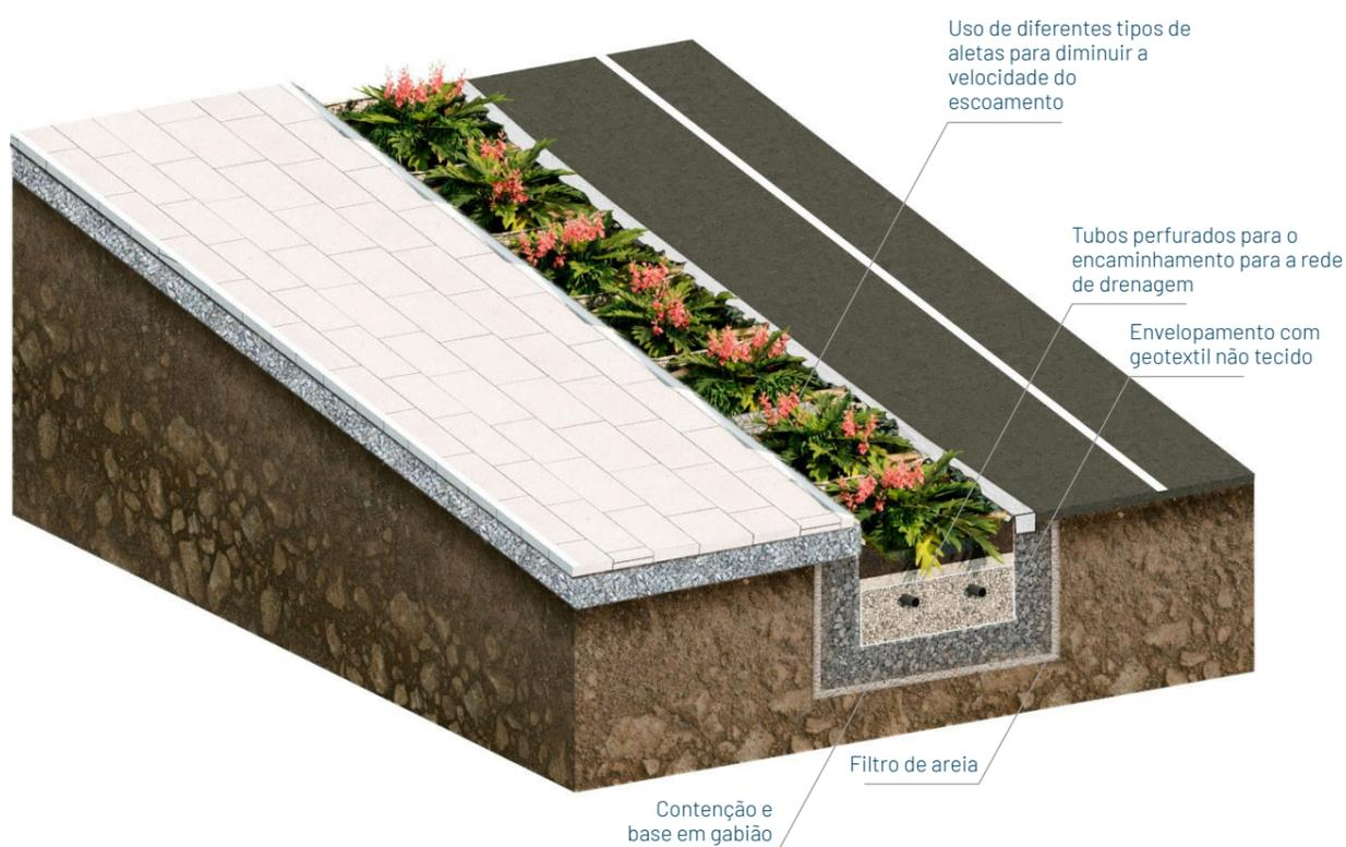
Figura 17 Escada hidráulica vegetada (Fonte: Guajava 2023).
