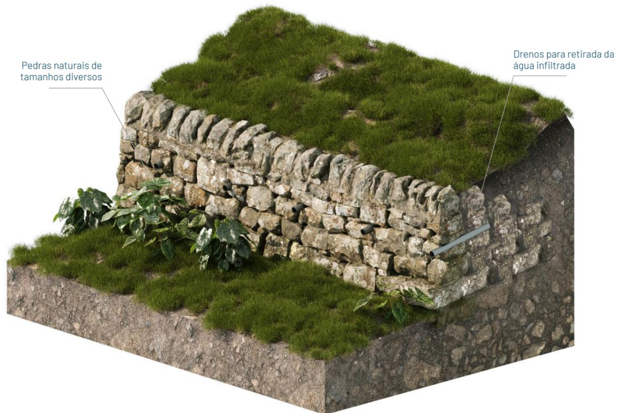
Muro de contenção com pedra é uma estrutura construída para estabilização do terreno em encostas e taludes. Constrói-se muros de suporte de até 10m de altura<sup>36</sup>, utilizando-se preferencialmente materiais obtidos próximos ao local, auxiliando na redução de custos de transporte de materiais. Quando não se dispuser de pedras no entorno, deve-se escolher aquelas que melhor se adaptam às características da região.
