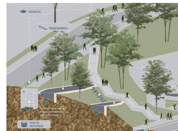
Figura 75 Área de Infiltração Saracura localizando as SbN: biovaletas, terraços de chuva, poços de infiltração, canteiro pluvial e reservatório subterrâneo
