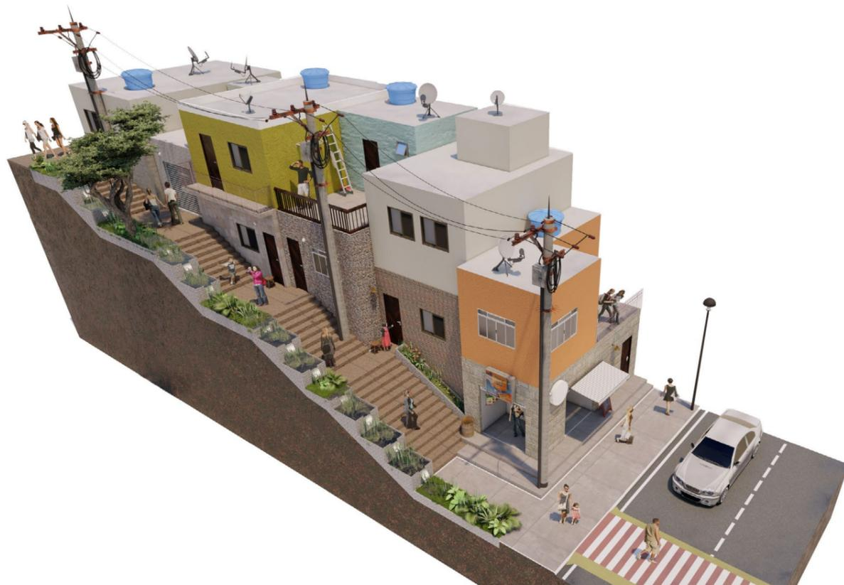
Figura 18 Escada hidráulica vegetada em projeto para as Grotas de Maceió/AL (Fonte: ONU e Guajava, 2021).
