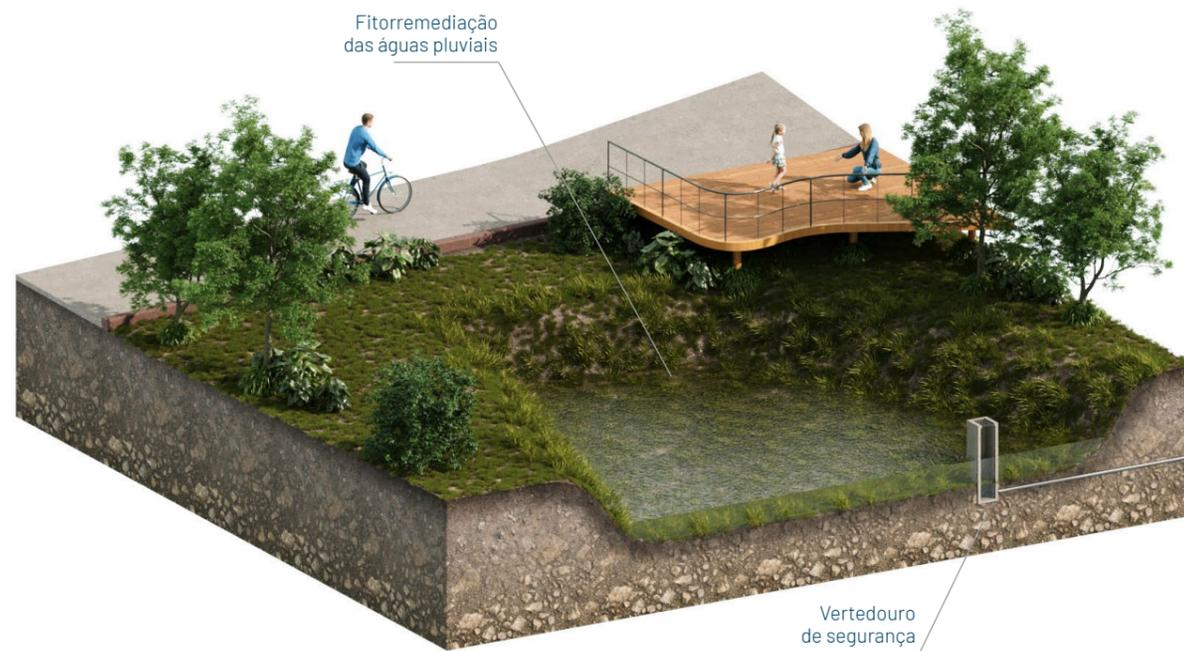
Figura 28 Bacia de infiltração (Fonte: Guajava, 2023).
