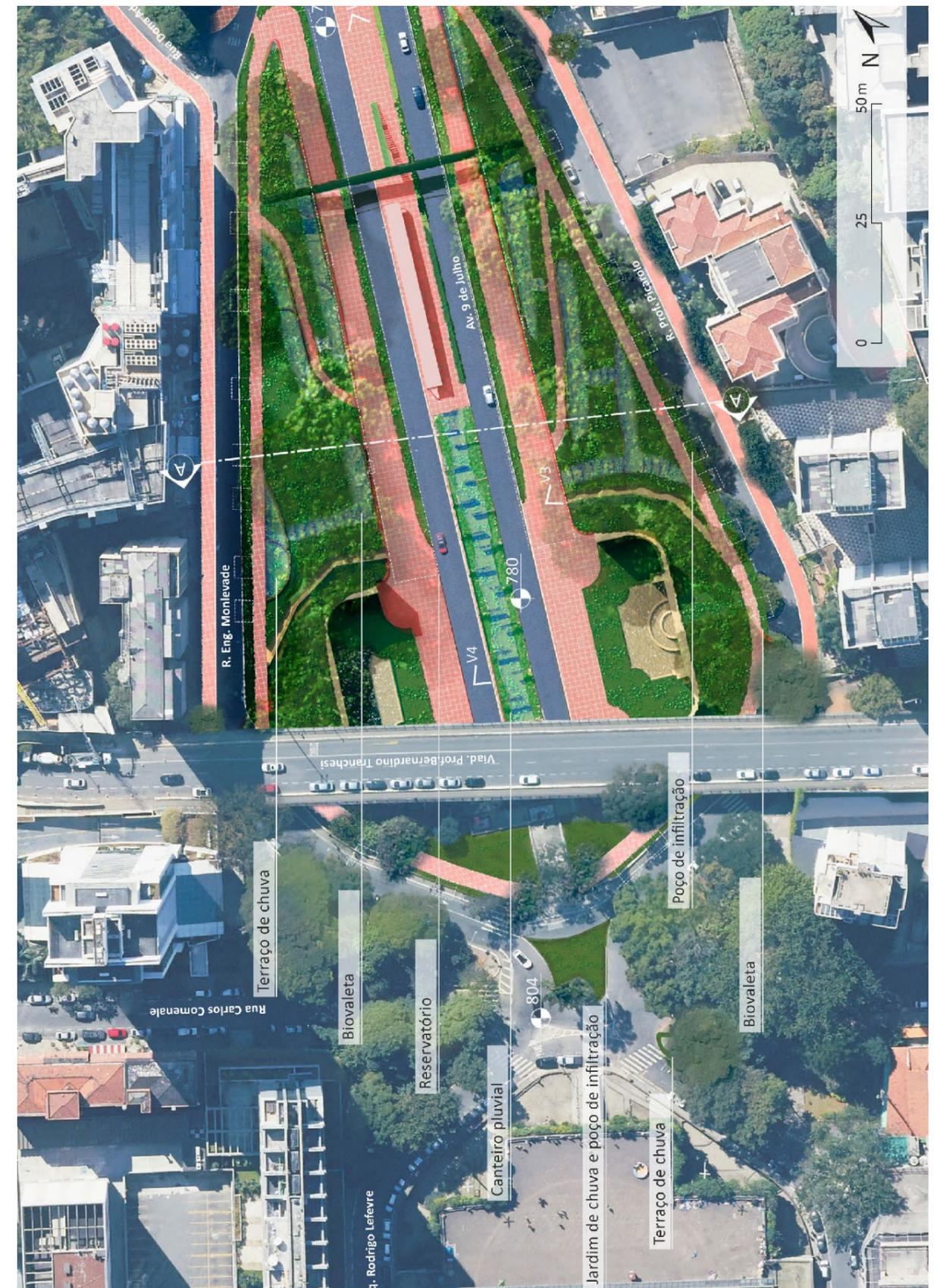
Figura 71 Planta da Área de Infiltração Saracura localizando as SbN: biovaletas, terraços de chuva, poços de infiltração, canteiro pluvial e reservatório subterrâneo (Fonte: Prefeitura de São Paulo, FCTH, 2021).
